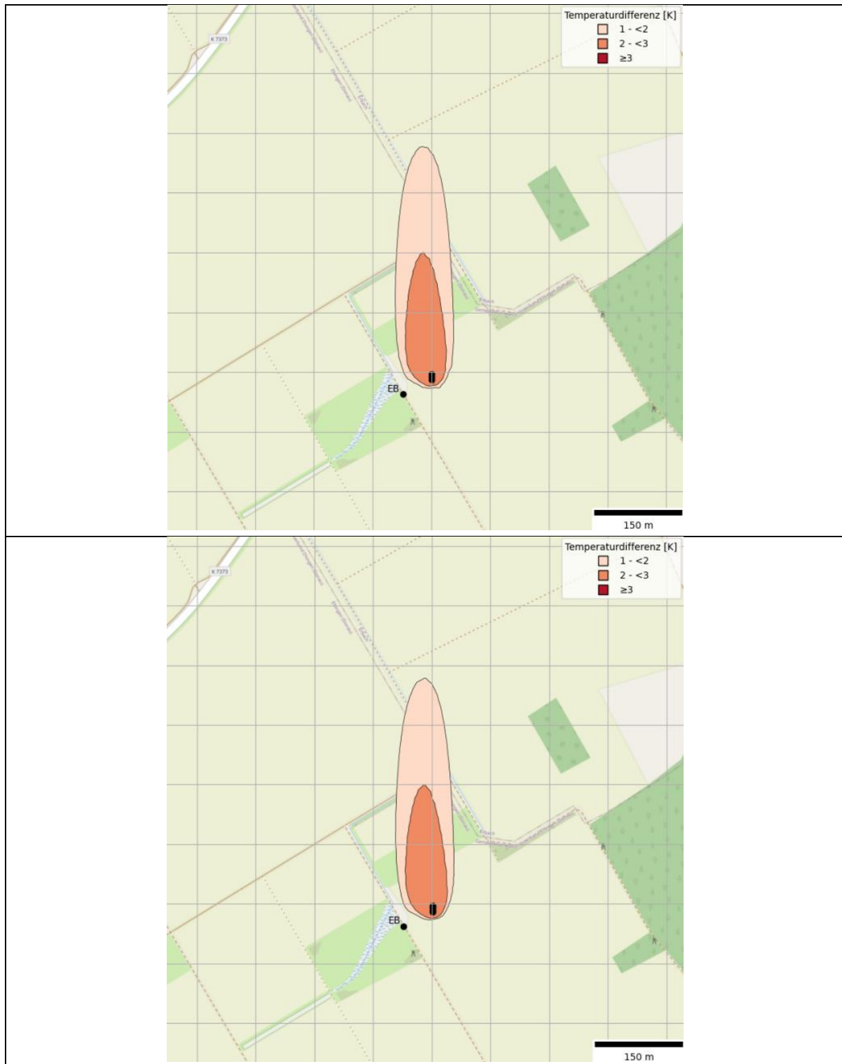
Abbildung 52: Vergleich der maximalen Ausbreitung der Temperaturfahnen für den Basisfall. Entnommen aus dem automatisierten Bericht (Abb. 2.4). Oben: Rigole umgesetzt mit 3 Rückgabebrunnen und einem Abstand zwischen den Brunnen von jeweils 5 m. Unten: Rigole umgesetzt mit 5 Rückgabebrunnen und einem Abstand zwischen den Brunnen von jeweils 2,5 m.
